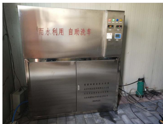
自助雨水洗车装置2.0版 (Self-serve rainwater car wash version 2.0)
